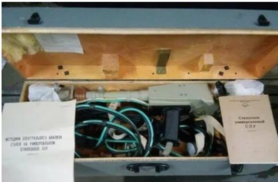
Рис. 9. Стилоскоп (СЛУ, Спектр)
